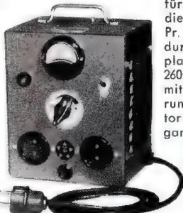
für Werkstatt und Kundendienst, Leistung: 300 VA, Pr. 110/125/150/220/240 V durch Schalter an d. Frontplatte umstellbar, Sek. 180-260V in 15 Stufen regelbar mit Glühlampe und Sicherung. Dieser Transformator **schaltet** beim Regelvorgang **nicht ab**, daher keine Beschädigung d. Fernsehgerätes.
