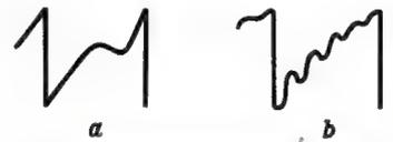
Der schlecht angelötete Kondensator im Impulsformer-Schwingkreis des Zeilensperrschwingers verhinderte die richtige Impulsform a und führte zu einer schwachen Zeilenstabilität (mit Impuls b)
