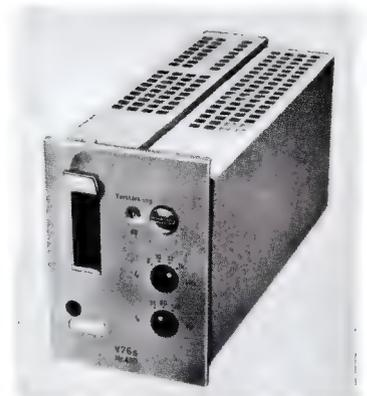
Bild 5. Studio-Mikrofonverstärker V 76
