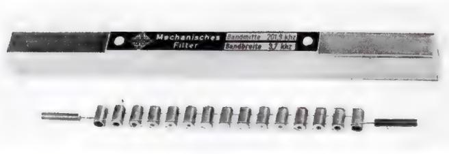
Bild 10. Mechanisches Filter mit 15 Torsionsschwingern. Oben das luftdicht verlötete Gehäuse (Länge etwa 160 mm), unten der Schwingkörper
